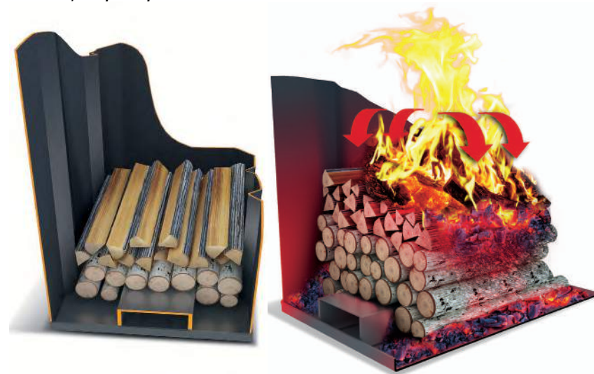
Рисунок 9.5. Варианты закладки дров в топку печи.
